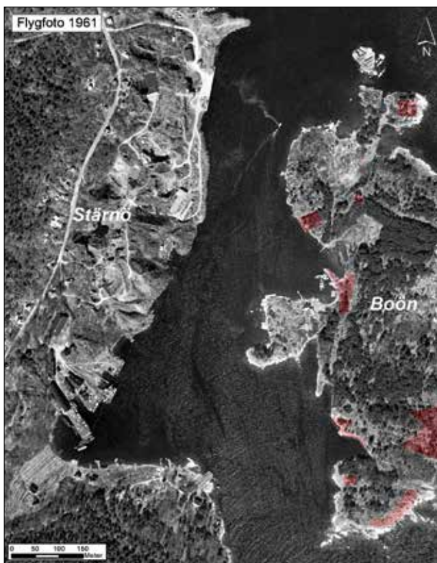
Figur 5 & 6. Genom att jämföra flygfotot från 1961 (till vänster) med flygfotot från 1975 (till höger) så ser man vilka omfattande utfyllnader som gjorts på Stärnösidan. Notera även broförbindelsen mellan södra Boön och Stärnö på den högra bilden. En försänkning av detta sund planerades redan på 1660-talet (figur 3) med det dröjde hela 300 år innan den blev av. Källa: Lantmäteriet.
