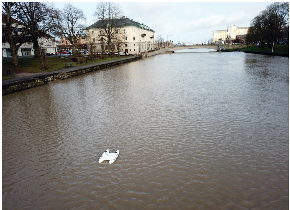
Figur 3. Sjömätningsfarkosten DeepCat under djupkarteringen på Lidan. I bakgrunden skymtar Torgbron. Foto: Jens Lindström/NMG.
