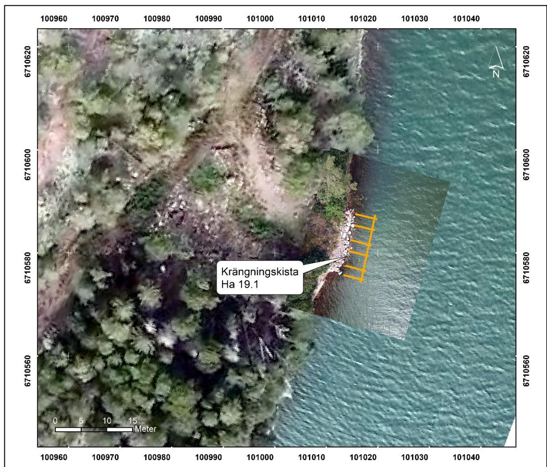
Figur 2. Rektifierade drönarfoton med krängkistans timmerkonstruktion utritad. De flesta av de kortare timren är inte synliga in mot land då de täcks med sten. Karta: Jens Lindström/NMG
